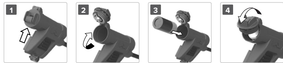
Figura 1 – Colocación de la batería
